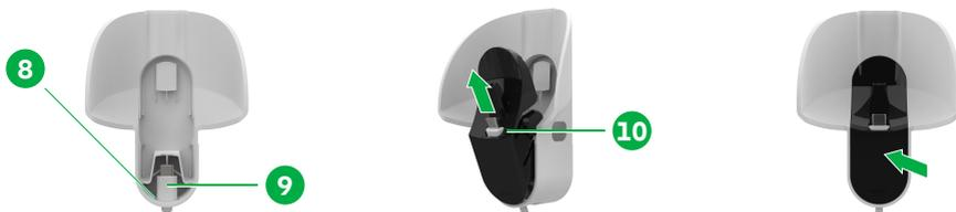
1. Fädle von unten durch die vorgesehene Öffnung (8) der Wandhalterung das USB-C<sup>®</sup>-Ladekabel. Schiebe dazu das USB-C<sup>®</sup>-Ladekabel mit dem Anschluss (9) voraus in die Wandhalterung.
