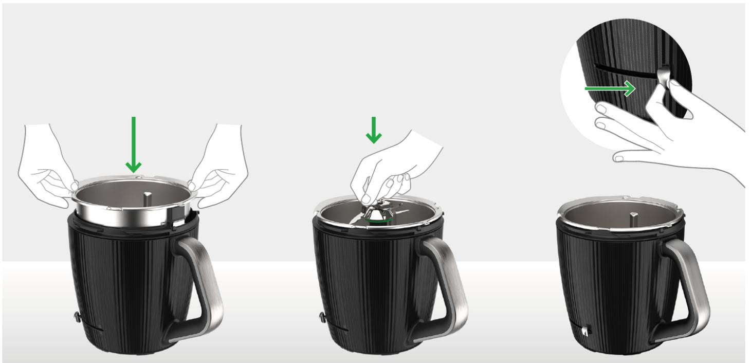
1. Setze den Edelstahlbehälter in die Isolierung. Die Positionierungshilfe des Edelstahlbehälters zeigt zum Mixtopf-Griff.
